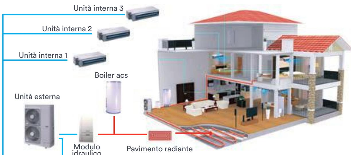
L'acqua calda sanitaria, oltre in modalità pompa di calore, può essere anche ottenuta sfruttando l'energia di scambio in funzione contemporanea di raffreddamento con unità split, aumentando l'efficienza con una maggiorazione che può arrivare fino a +10%.
