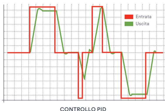
Il regolatore PID (Proporzionale-Integrale-Derivativo) permette di diminuire i tempi di risposta e garantisce la precisione del funzionamento dei ventilconvettori.
