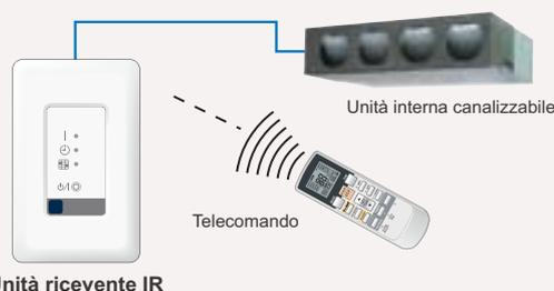
Necessaria per il controllo di tutti i modelli canalizzabili da telecomando.
