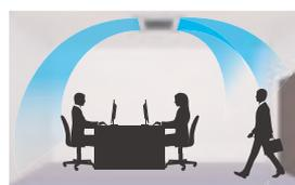
Climatizzazione confortevole evitando flussi diretti d'aria e variando in continuo la posizione delle alette (swing).
